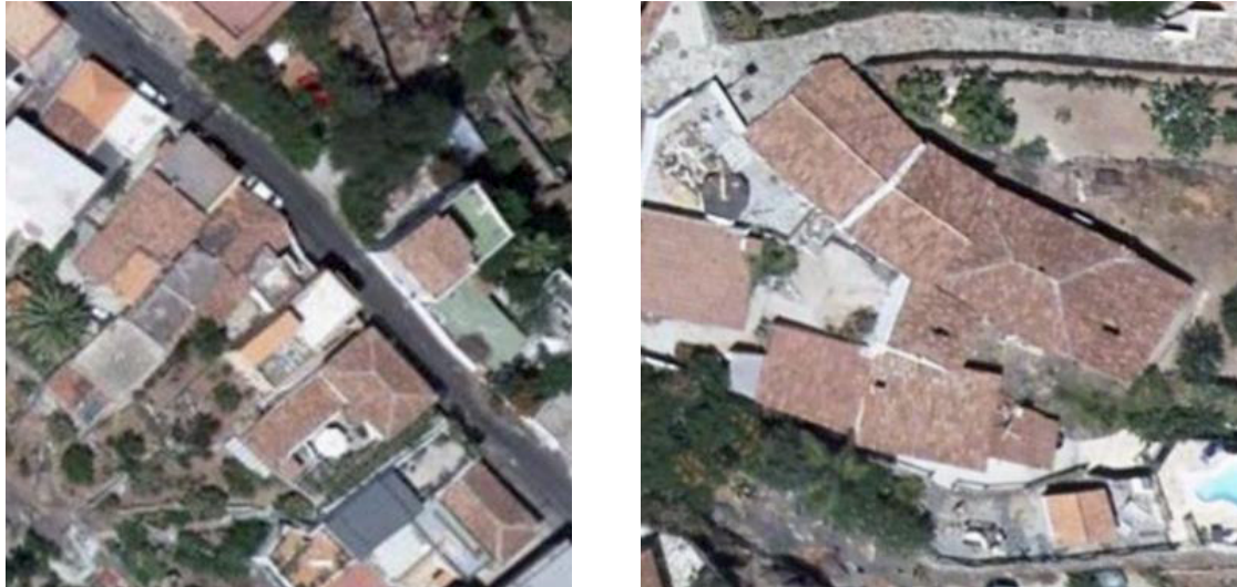
Ilustración 88.- Imagen izq. Distintas disposiciones de las crujías: formación en "L" y paralelas o perpendiculares a la vía. Imagen dcha. Crujías alineadas
